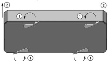
2. В овальные отверстия 15x5, соответствующие установочным размерам, установить опоры пластиковые (входят в комплект поставки).
