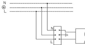
2. Схема подключения светильника к питающей сети с блоком резервного питания (на рис. а - светильник, б - блок резервного питания).
